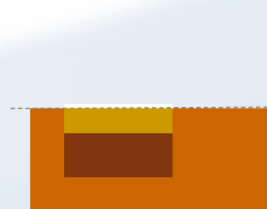
④覆土・転圧
