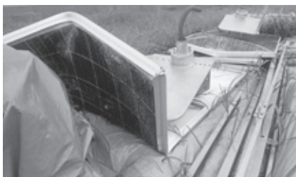
破損した追尾型太陽光発電システム
