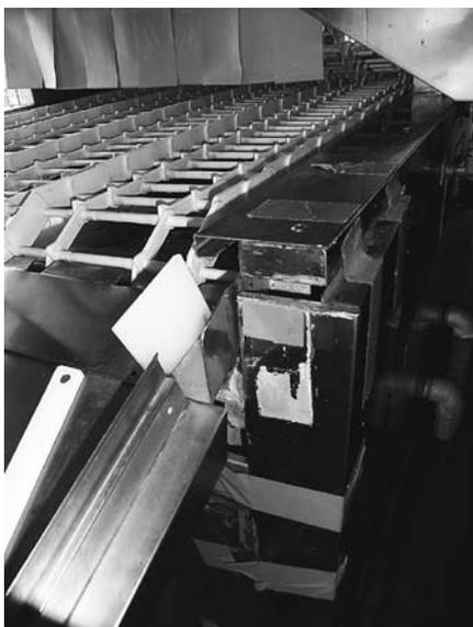
補修して使用している食器洗浄機
