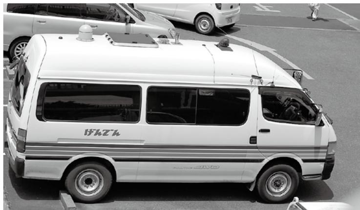
県の委託を受け役場の駐車場にて放射線量を測定している放射線測定装置搭載自動車
